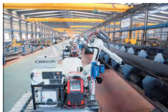
单梁主梁内缝机器人焊接生产线
