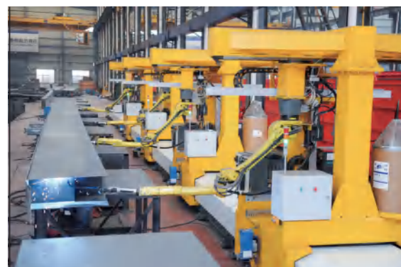
双梁主梁内缝机器人焊接生产线
