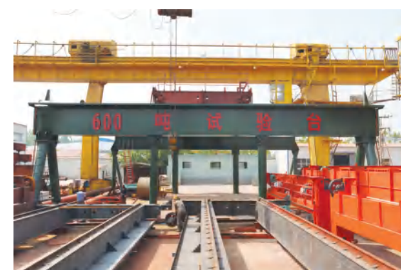
600吨桥式起重机试验台
